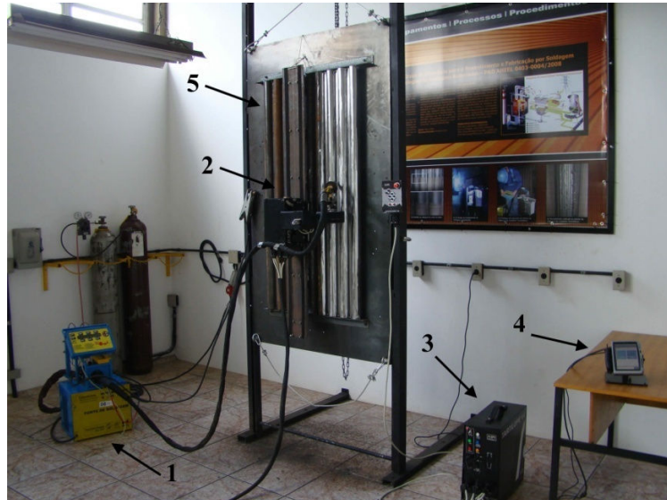
Figura 5. Bancada basculante para revestimentos de paredes tubulares.
