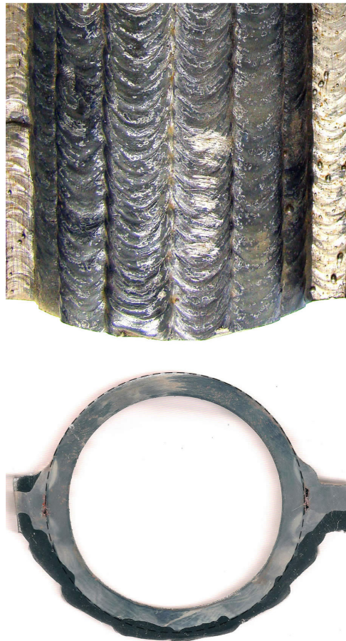
Figura 7 – Resultado do revestimento MIG/MAG com tecimento simultâneo dos eixos Y e Z.
