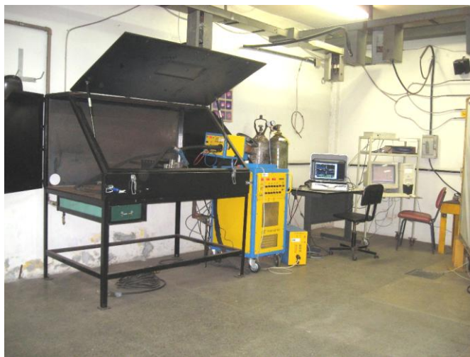
Figura 4. Bancada de experimento do processo MIG/MAG-PS para soldagem de revestimento.
