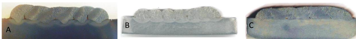
Figura 5. Tentativas de revestimentos sem falhas usando o processo MIG/MAG com polaridade negativa.
