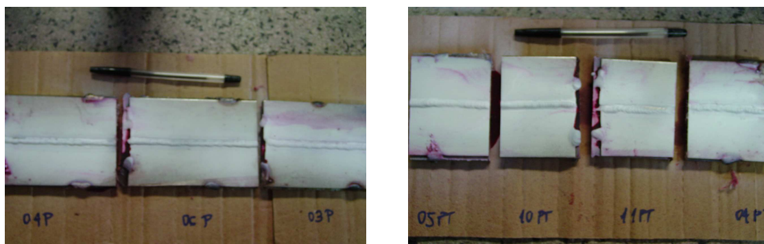
Figura 5 – Ausência de trincas e poros após ensaio por líquido penetrante para o MAG-P e MAG-PT
