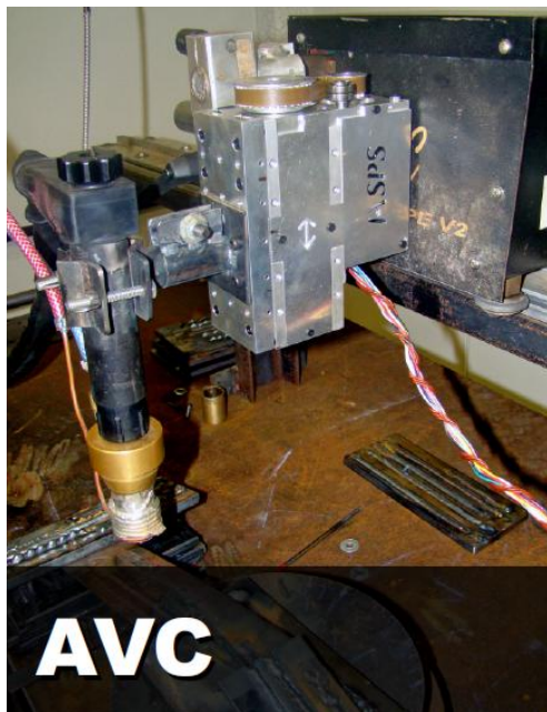
Sistema de abertura e controle do arco. (Foto: Marcelo Okuyama)
